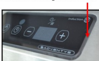
Joint silicone et montage en affleurement
